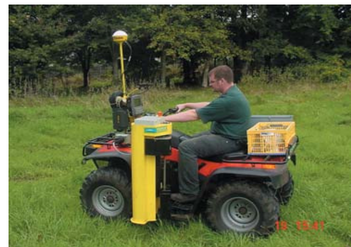
Moto-quatro adaptada para recolha de amostras de solo geo-referenciadas.
