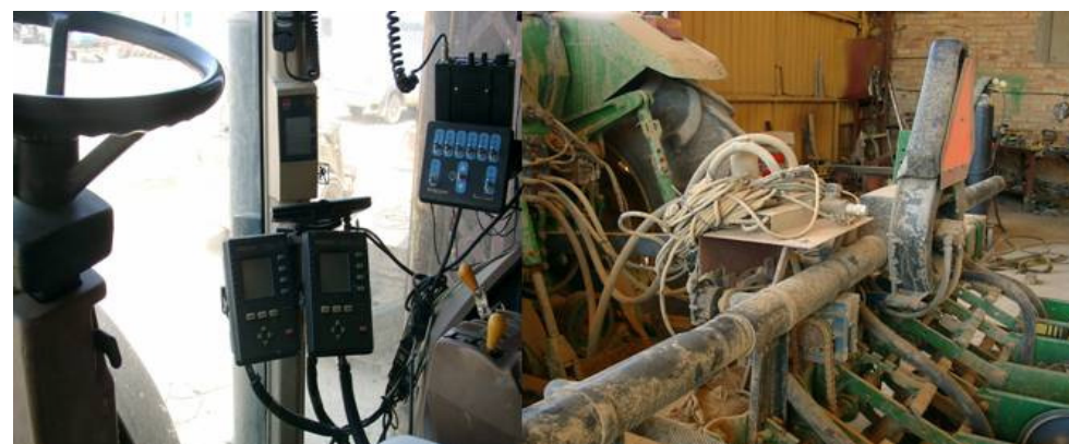
Sistema de VRT de semente Dickey-John instalado num semeador John Deere
